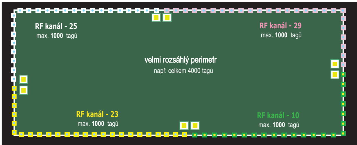
obr. 21 - Dispozice rozdělení RF kanálů ve velmi rozsáhlých perimetrech II.
